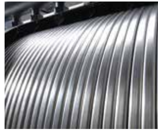
Топлообменник Inox-Radial от неръждаема стомана
